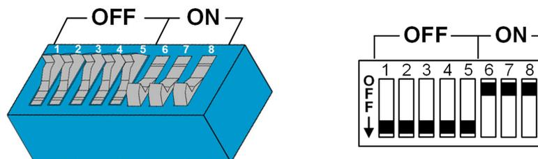
Die DIP-Switches befinden sich unter der Anschlussfeldabdeckung. Die folgende Abbildung zeigt nur die betroffenen DIP-Switches, andere werden nicht dargestellt. Folgende Einstellung am DIP-Switch DSW2 muss getätigt werden:
