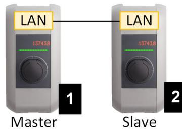
Abb. 2-3: Direkte Verbindung von Master und Slave
